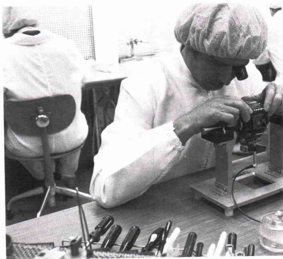
Glappsättning av gyrokardan – toleransvidd 0,15 \mu\text{m}
