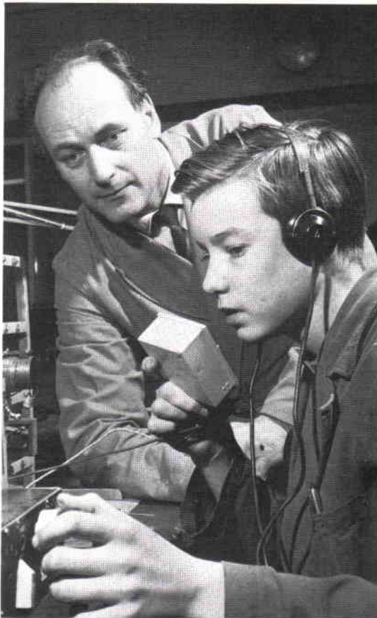
Folke Sundholm med en av telemontörerna. Funktionskontroll pågår av den egenhändigt byggda radiosändaren (Hartleykopplad oscillator) med hjälp av en gammal flygradiomottagare (FR2?).
